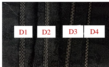
Slika 5: Tekstilni vzorec z všitima prejama na različnih medsebojnih razmikih, od največjega razmika z oznako D1 do najmanjšega razmika z oznako D4.
