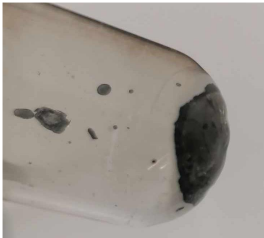
Slika 1: Fotografija spodnjega dela epruvete, ki je po reakciji med litijem in steklom valovita.
