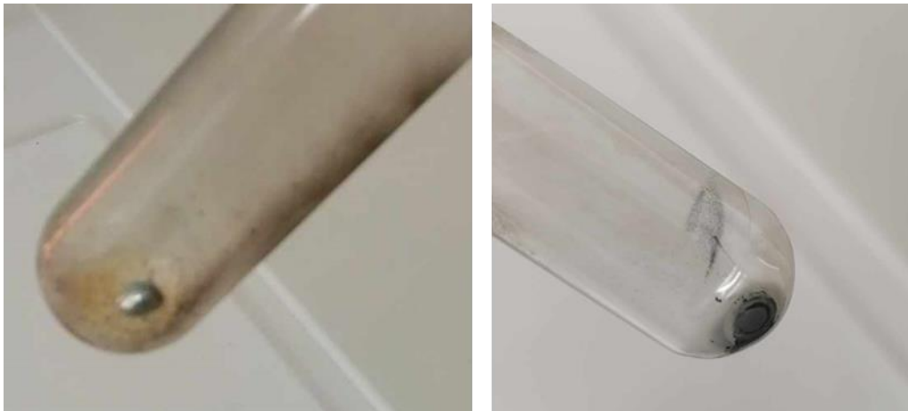
Slika 5: Ob segrevanju se natrij hitro stali (levo), nato nastanejo natrijev oksid, natrijev peroksid in natrijev superoksid (desno).
