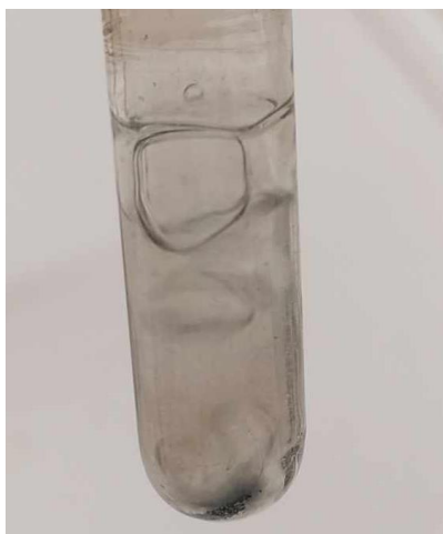
Slika 3: Ostanek litija v epruveti Schott Supremax burno reagira z vodo, pri čemer nastaja vodik.
