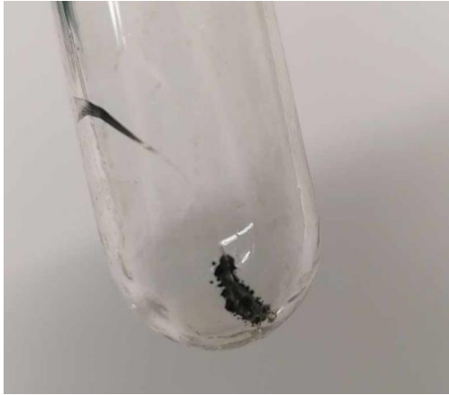
Slika 4: Ostanek črne snovi po reakciji z vodo v epruveti Schott Supremax.
